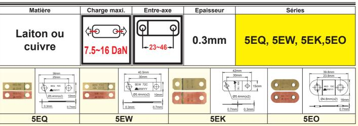
Réalisés en métal de faible épaisseur, ces maillons fusibles ont le temps de réponse le plus court, entre 2 minutes 50 secondes et 3 minutes, pour une vitesse de montée en température de 20°C/min depuis 25°C, mais la finesse du métal limite leur résistance mécanique.
