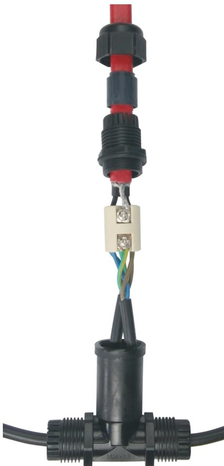
Faites glisser le bornier céramique dans le corps, en le poussant et en tirant simultanément sur les câbles ronds. Vissez ensuite le corps du presse étoupe A, sans y avoir entré la garniture du câble méplat.
