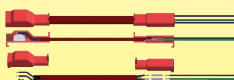
Ruban sur thermostat à disque et sur fils
