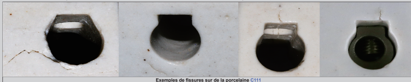
Exemples de fissures sur de la porcelaine C111
