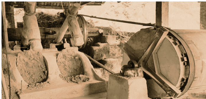
Machines de production traditionnelle des poudres (水確 shui dui), utilisées pour fabriquer de la porcelaine électrique (collection privée)
