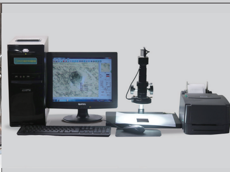
Mesure électronique au microscope du diamètre de l'indentation (Laboratoire Ultimheat)
