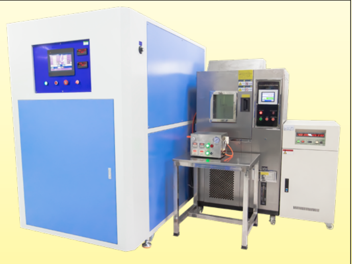
Equipement d'essai de durée de vie électrique des air switches. (Utilisé pour la vérification de la conformité aux normes UL et CE applicables)
